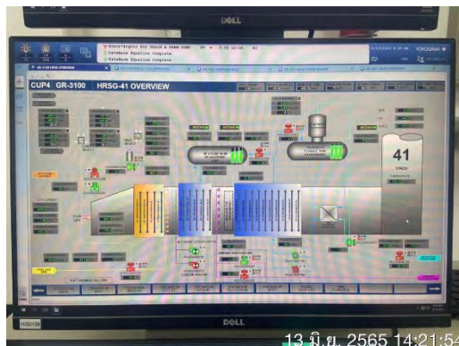
ภาพที่ 2.2-48 ระบบ Distributed Control System (DCS)
