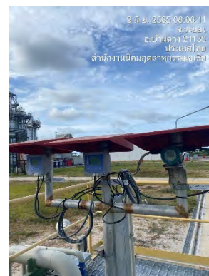
ภาพที่ 2.2-8 เครื่องตรวจวัดคุณภาพน้ำแบบอัตโนมัติ
